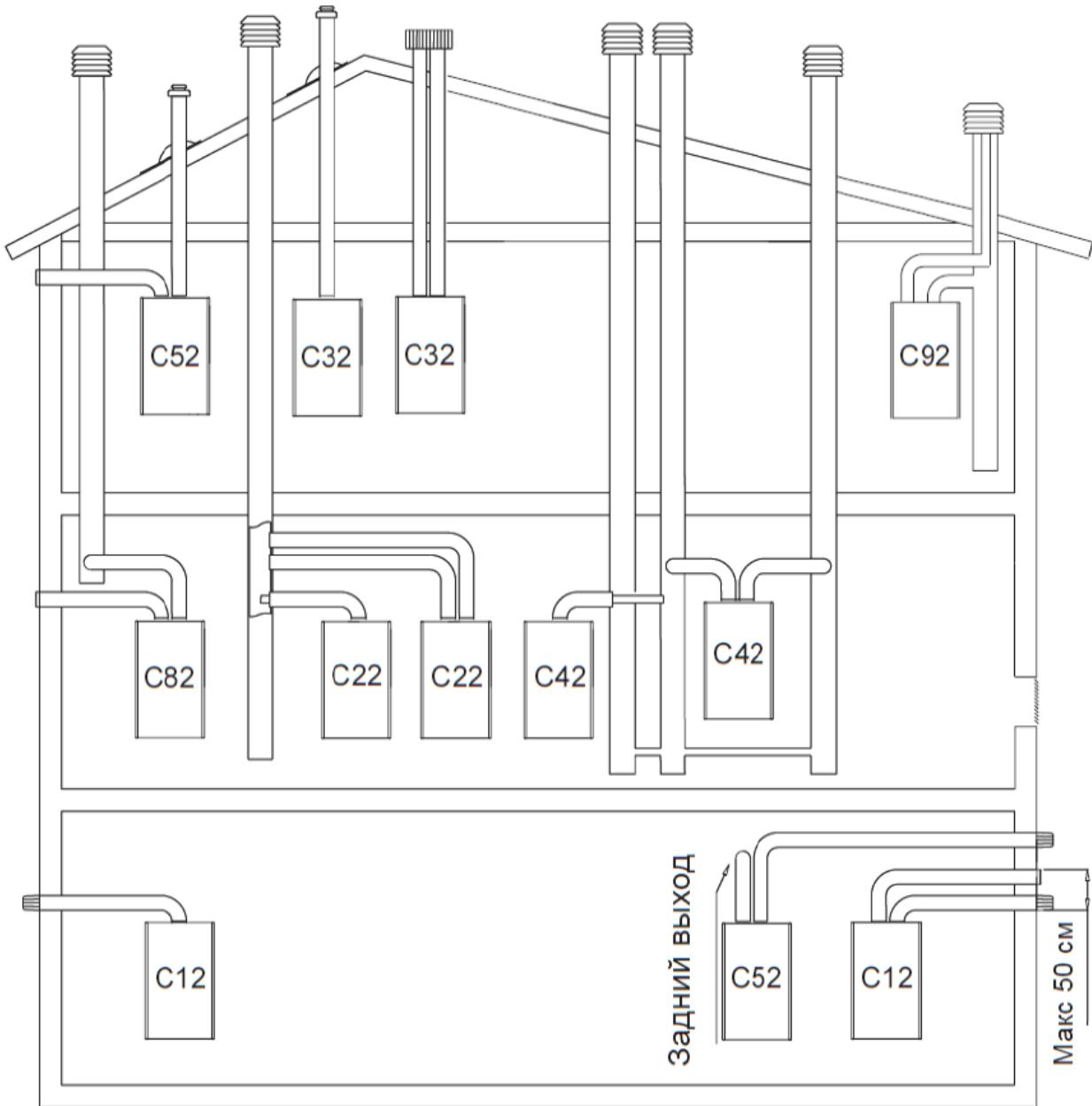
**C12-C12x** Выход дымовых газов через коаксиальные дымоотводы/воздуховоды. Дымоотводы и воздуховоды могут быть раздельными или коаксиальными. В случае использования раздельных дымоотводов/воздуховодов их выходы наружу должны быть расположены достаточно близко, чтобы находятся в одинаковых ветровых условиях
