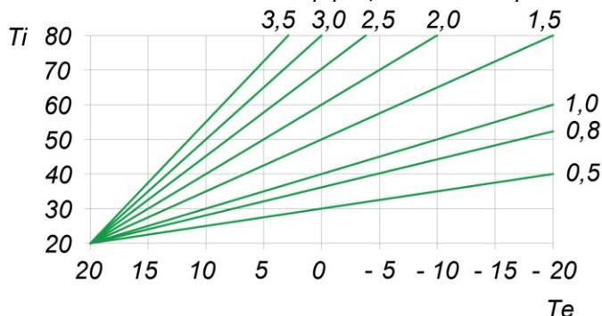
Значения температурных кривых для  $T_{Room} = 20^\circ\text{C}$
