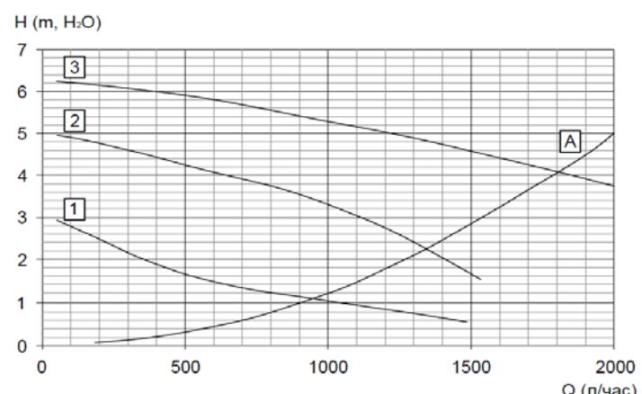
Циркуляционный насос оснащен переключателем скоростей, который даёт возможность для уменьшения возможного шума, возникающего при большой скорости движения жидкости в отопительной системе.
