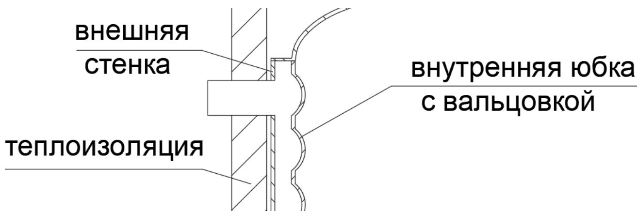
2.1. Бойлер FB INOX (H) сконструирован по схеме внутренний бак бойлера (контура горячего водяного снабжения (далее ГВС) с водяной юбкой (контура обогрева бойлера через систему отопления (далее СО). Для повышения производительности внутри водяной юбки предусмотрены направляющие потока воды. Для увеличения прочности, внутренние стенки имеют вальцовку.
