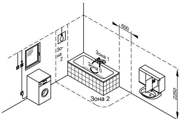
Электрооборудование в помещениях с ванной или душем должно быть смонтировано таким образом, чтобы исключить опасность поражения электрическим током. Согласно VDE 0100 кабели электропитания для стационарно смонтированных электроприборов в зонах 1 и 2 разрешается прокладывать только вертикально с вводом в прибор с задней стороны.
