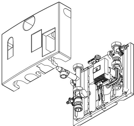
Комплект для подключения емкостного водонагревателя
