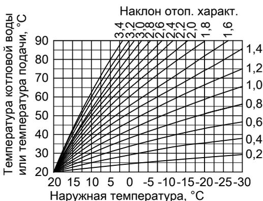
Подъем температуры подачи ограничен терморегулятором "i" и максимальной температурой, заданной на контроллерах отопительных контуров Vitotronic 100, тип HC1B.
