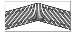
Безразъемный плавный угловой переход с роликовой решеткой
