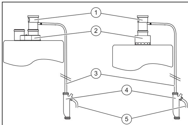
9. Вставьте отвод конденсата (1) в присоединительный элемент (2).
