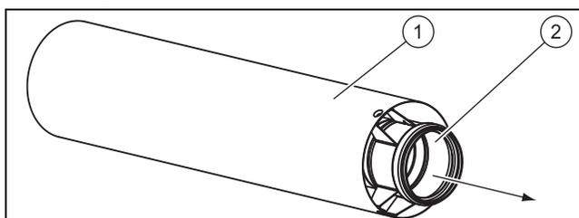
1. Вытяните трубу отходящих газов (2) из трубы воздуховода (1).
