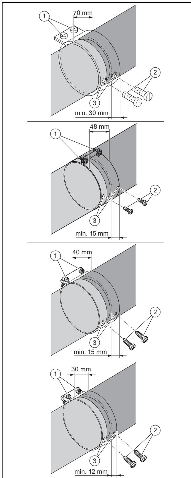
2. Надвиньте хомут воздуховода на стык труб воздуховода и затяните винты (1).
