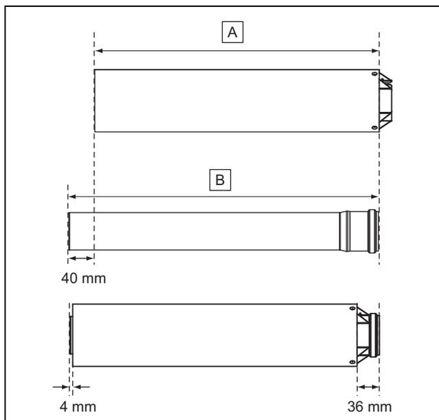
2. Сначала отмерьте необходимый кусок воздуховода (A), а затем рассчитайте соответствующую длину трубы отходящих газов (B):
