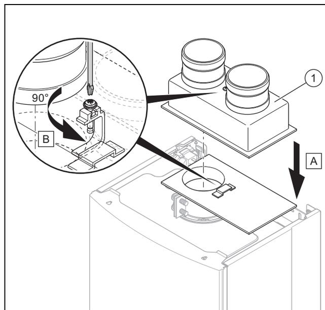
5. Установите присоединительный элемент на пластину-адаптер.
