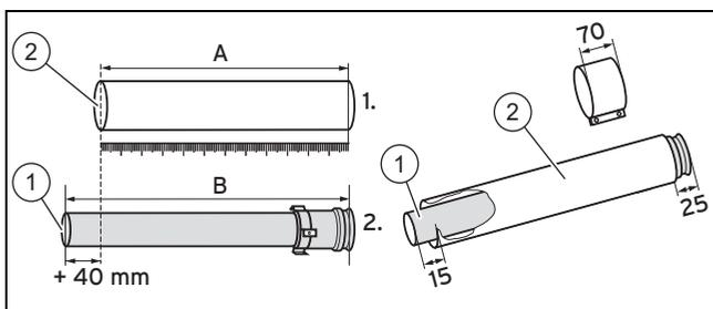
7. Сначала отмерьте необходимый кусок воздуховода (A), а затем рассчитайте соответствующую длину трубы отходящих газов (B):
