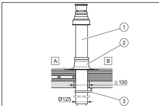
A Неутепленная крыша      B Утепленная крыша
