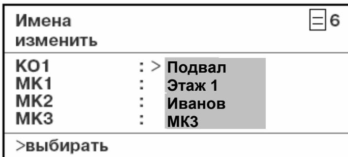
Каждому отопительному контуру можно присвоить индивидуальное имя. Название каждого контура может быть максимум 10 букв длиной. Выбранные обозначения перенимаются автоматически и отображаются в соответствующих меню.
