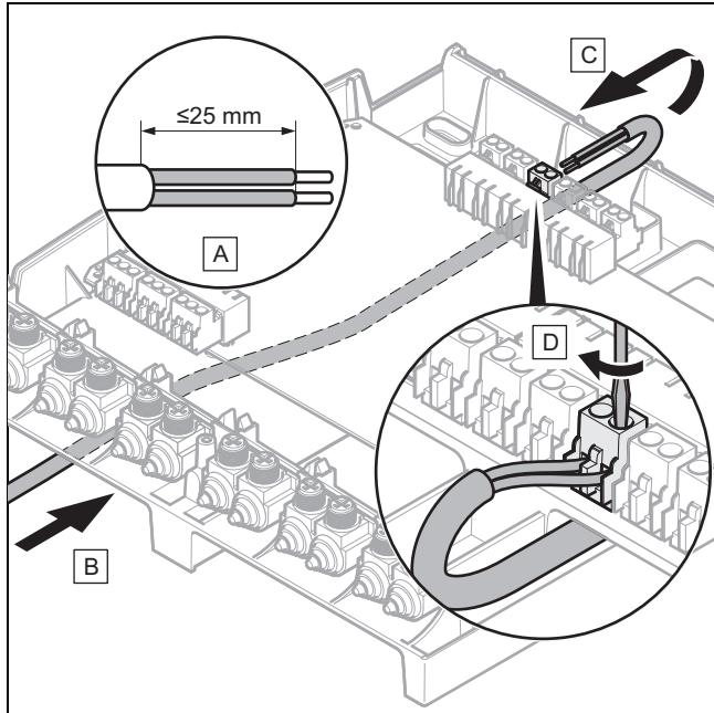
5. Протолкните подключаемый кабель между стеной и настенным цоколем к верхней клеммной колодке.
