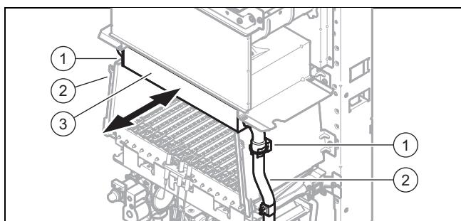
2. Снимите скобы (1) на трубе подающей и обратной линии.
