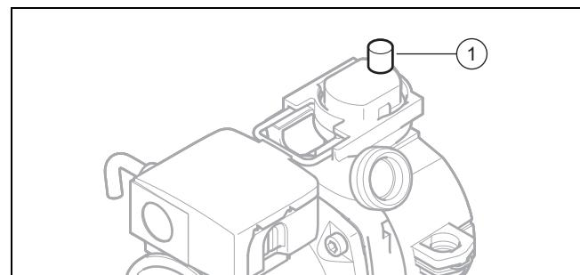
4. Снимите колпачок (1) быстродействующего воздухоотводчика.
