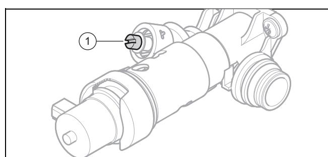
3. Отрегулируйте давление регулировочным винтом (1).
