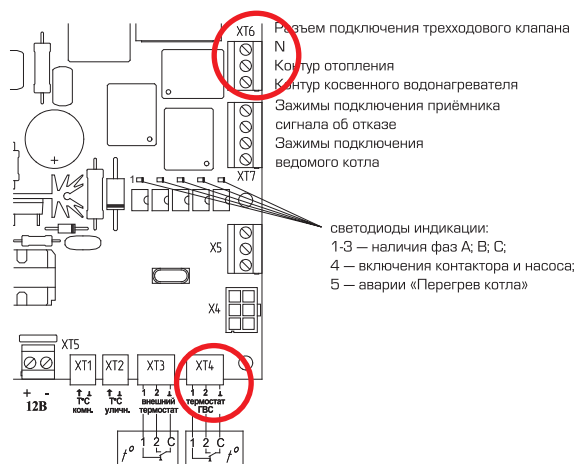
Рис. 13. Схема подключения датчика температуры бойлера
