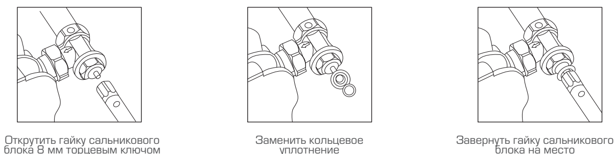
Рис. 21. Замена кольцевого уплотнения штока клапана терморегулятора
