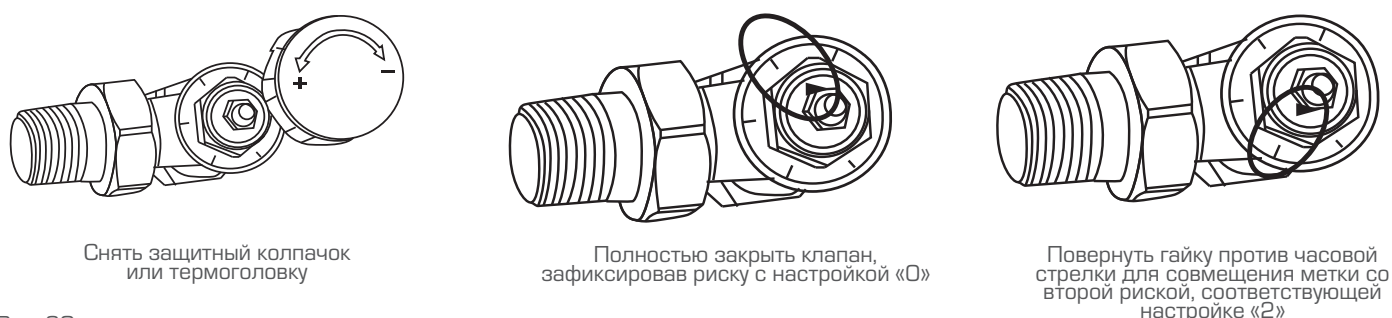
Рис. 20. Пример преднастройки клапана терморегулятора
