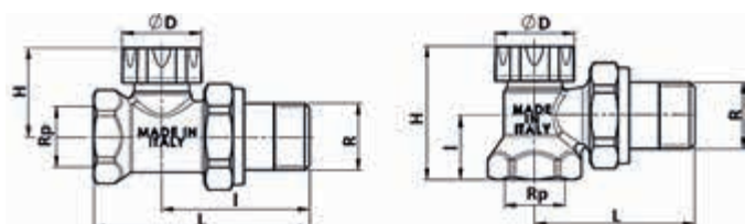
Рис. 31. Устройство запорно-балансировочного клапана типа SVL
