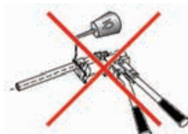
Рис. 4. Последовательность монтажа фитингов с надвижными гильзами
