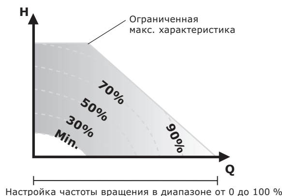
Рис. 74 Ограничения по мощности и давлению, влияющие на максимальную характеристику
