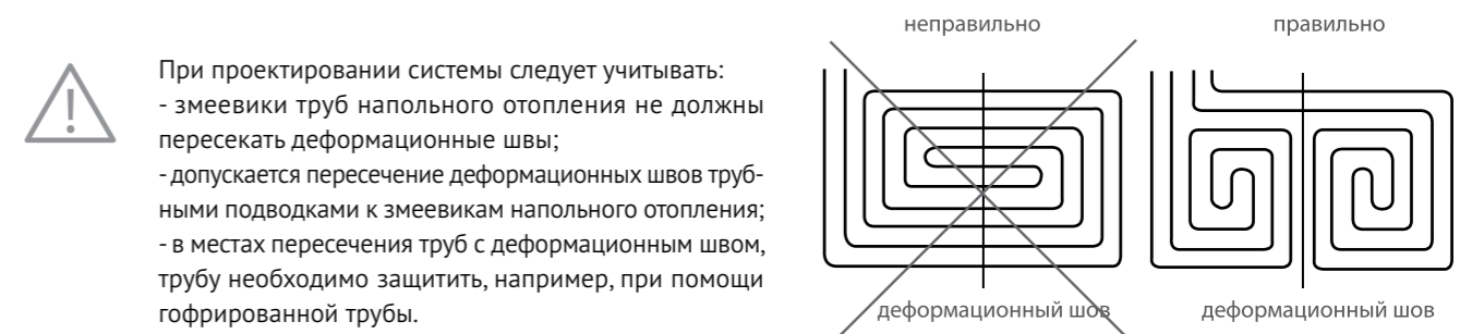
Рисунок 44. Пересечение деформационного шва
