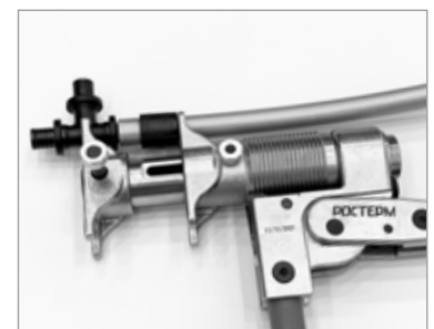
6. Вставьте фитинг в зажимной инструмент
