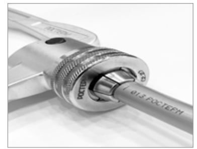
3. Проведите экспандирование трубы РЕ-Х в три этапа (30%, 70%, 100%), между этапами проворачивая экспандируемую трубу на 30° вокруг своей оси
