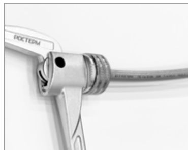
2. Вставьте наконечник насадки в трубу РЕ-Х
