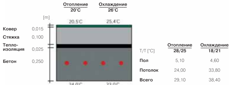
5 Рис. 46: Конструкция плиты 1
