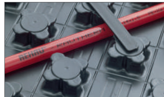
Рис. 15.5-18 Фиксирующие скобы С помощью фиксирующих скоб трубы надежно фиксируются на матах под углом 45°.
