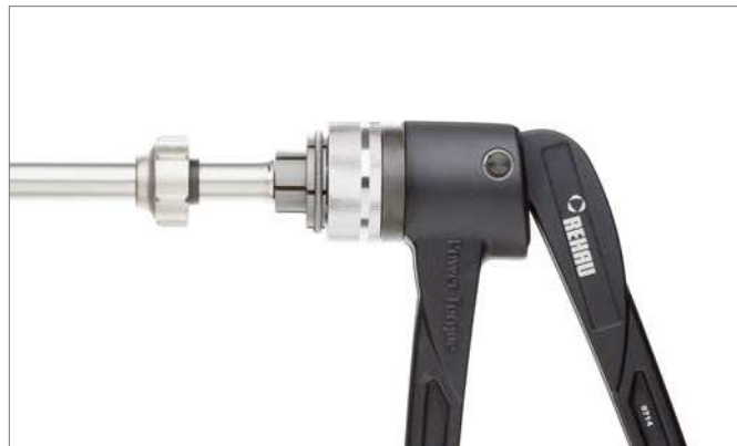
Рис. 14.4. Однократное расширение конца трубы
