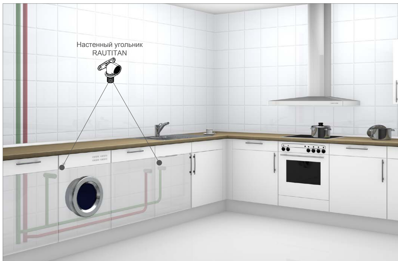
Рис. 5-2. Прокладка Т-образной трубки при поэтажной / индивидуальной линии водопровода с объемом < 3 л - на примере кухни
