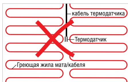
Неверное размещение термодатчика
