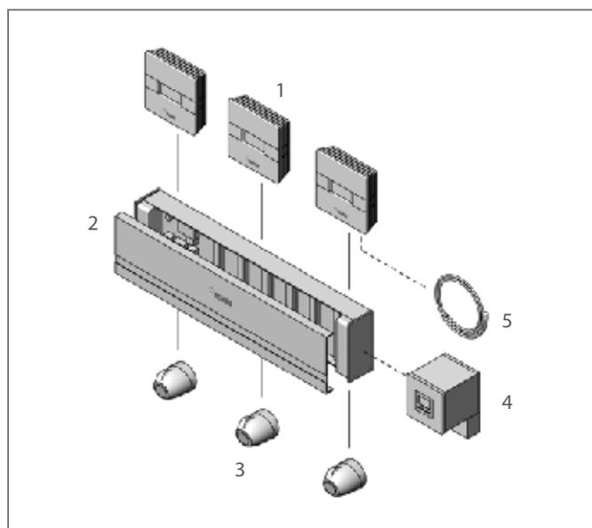
Рис. 2-2 Конфигурация системы регулирования Nea 230 В <sup>1)</sup>
