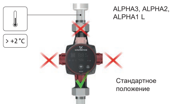
Рис. 17 Возможное положение блока управления для системы отопления
