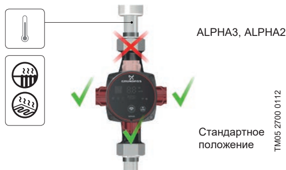
Рис. 18 Возможное положение блока управления для системы охлаждения и кондиционирования воздуха
