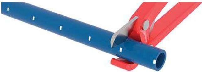
Труба обрезается ножницами перпендикулярно к оси трубы. Чтобы предотвратить сплющивание трубы следует трубу в ножницах повернуть.
