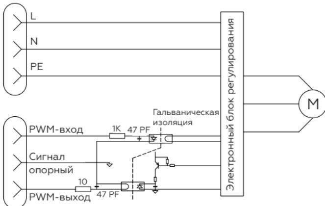
Входной сигнал PWM (P1 – отопление).
