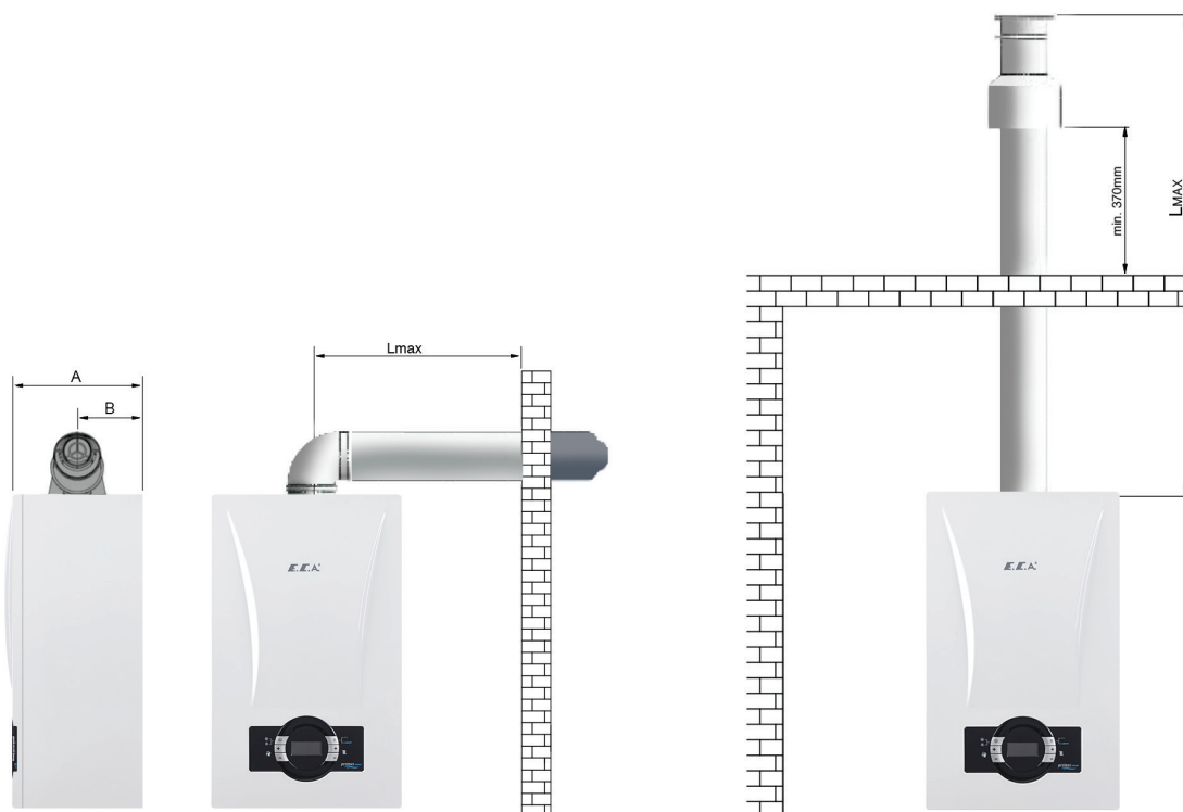
Горизонтальный коаксиальный дымоход Максимальная длина L макс. : 10 м, Ø60/100 Максимальная длина L макс.: 20 м, Ø80/125
