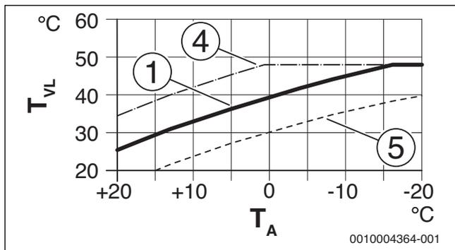
Рис. 36 Настройка отопительной кривой для обогрева полов
