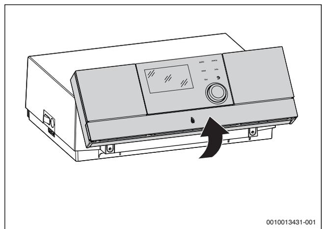
Рис. 15 Регулировка наклона
