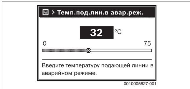
Рис. 42 Температура подающей линии для аварийного режима
