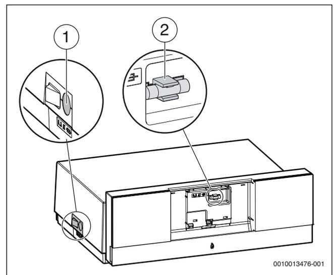
Рис. 41 Замена предохранителя
