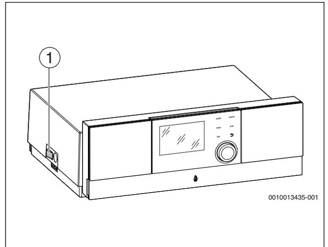
Рис. 18 Включение/выключение
