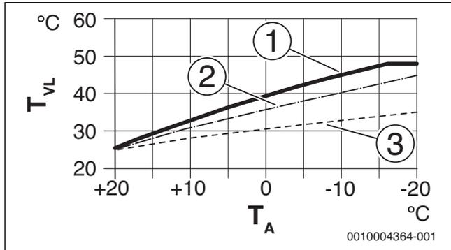
Рис. 35 Настройка отопительной кривой для обогрева пола
