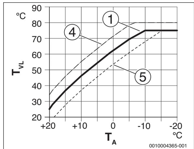
Рис. 38 Настройка отопительной кривой для радиаторов
