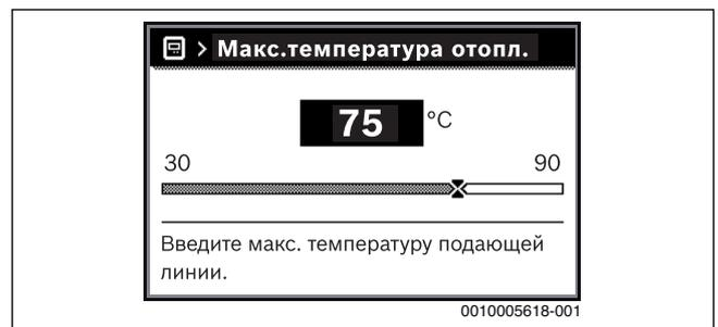
Рис. 25 Установка максимальной температуры подающей линии
