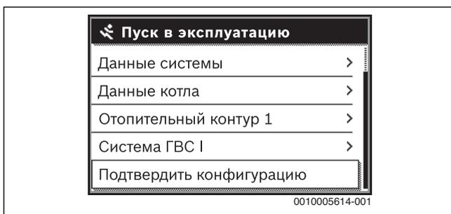
Рис. 22 Меню пуска в эксплуатацию - подтверждение конфигурации
