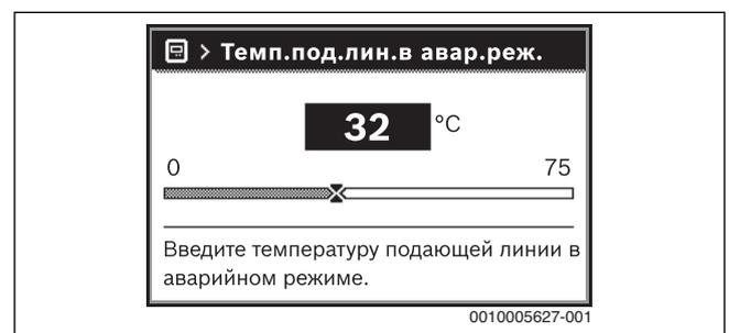
Рис. 30 Температура подающей линии для аварийного режима
