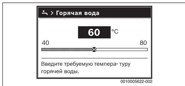
Рис. 27 Установка максимальной температуры горячей воды
