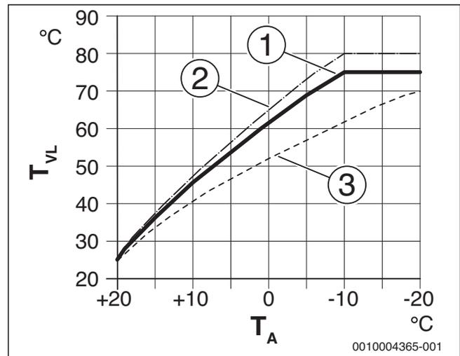
Рис. 37 Настройка отопительной кривой для радиаторов
