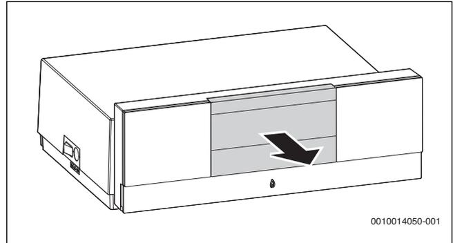
Рис. 13 Снятие крышки
