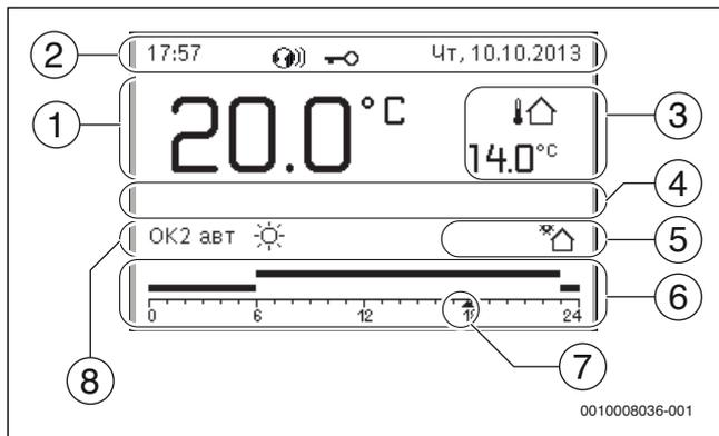
Рис. 20 Условные обозначения в стандартной индикации (вариант экрана)
