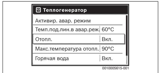
Рис. 23 Включение отопления
