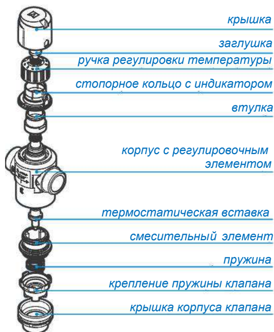
Рис. 2: Конструкция клапана ATM Kvs = 3,2 м³/ч и 4,2 м³/ч
