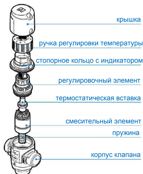
Рис. 2: Конструкция клапана ATM
