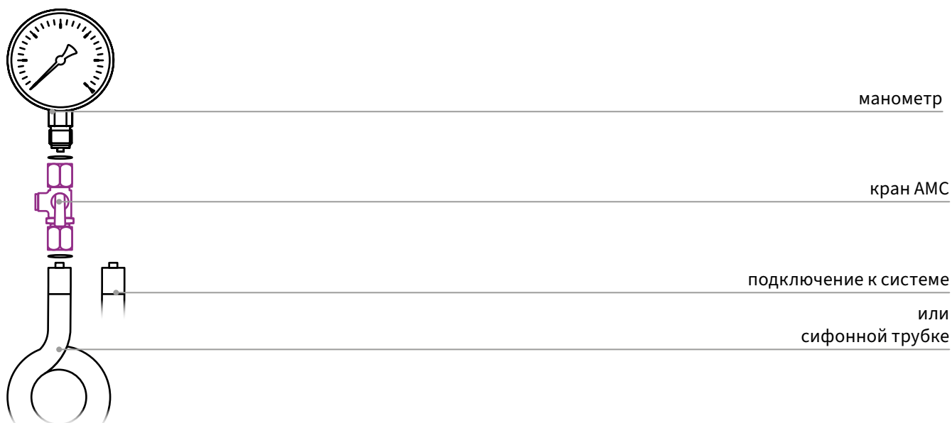
1. Измерение напора циркуляционного насоса (разница давления между всасывающей и напорной трубками).
