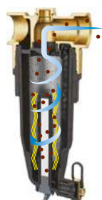
Шаг 1: Притяжение загрязнений магнитом.
