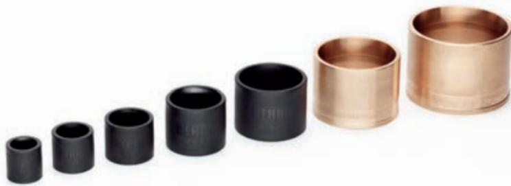
С фитингами RAUTITAN PX, MX, RX и SX Dy 16-40 мм применяются полимерные надвижные гильзы, изготовленные из PVDF (поливинилденфторид) и демонстрирующие столь же высокие прочностные и гигиенические показатели. Латунные надвижные гильзы используются только с фитингами RAUTITAN MX Dy 50-63 мм.
